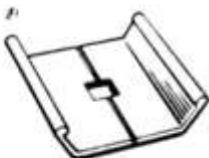
Рис. 3.19. Шайба для крепления легкобрасываемых элементов а – ослабление сечения шайбы; б – шайба с надрезом; в – вид шайбы после срабатывания легкобрасываемых (стеновых) элементов
